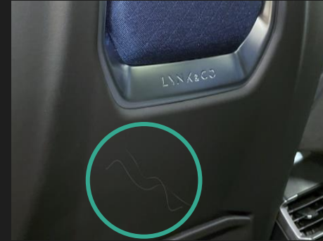
Revor eller hål i inredningens material.
