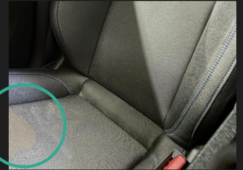
Missfärgning eller mögel i inredningens material.
