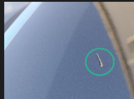
Skador på karossen, t.ex. bucklor eller repor där lacken har skadats ner till underlaget.
