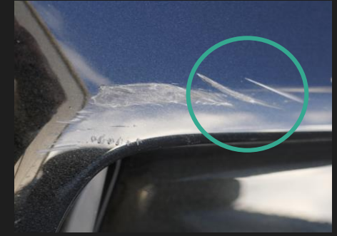
Färgflisor där korrosion har uppstått.
