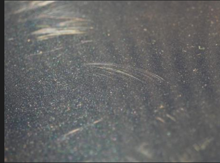
Små bucklor som är mindre än 20 mm. Tre eller färre bucklor per panel.
